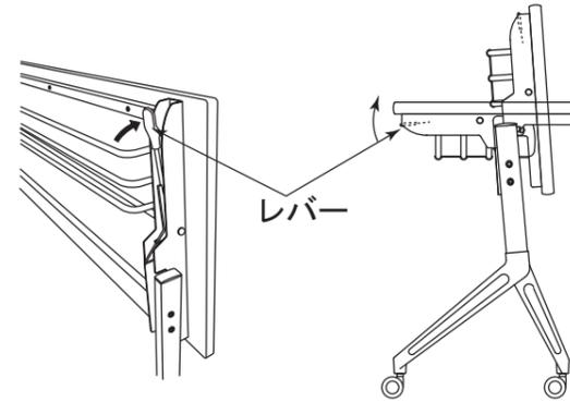
折畳み収納の際、約137mmのピッチでコンパクトにネスタングできます。
