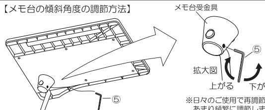
メモ台受金具内の止めネジを、付属の⑤六角レンチ（小）で回転させると、角度が調節できます。
