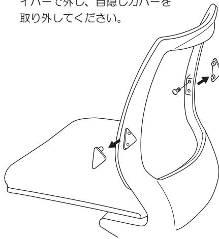
(2) 次に目隠しカバーを取り外した凹みに①肘を組み付けて、付属の②ボルトを③六角レンチでしっかりと固定してください。
