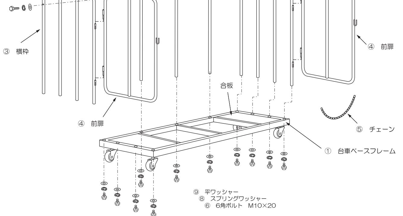
**手順1** ①台車ベースフレームに③横枠を差込み、⑨平ワッシャー⑧スプリングワッシャー⑦6角ボルト（M10×20）で8箇所仮締めしてください。
