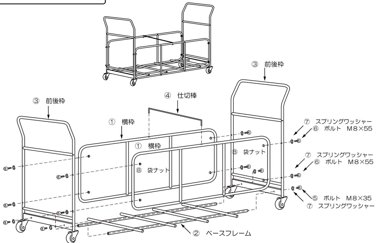
**手順1** ②ベースフレームと③前後枠を、⑤ボルト（M8×35）に⑦スプリングワッシャーを入れ、⑨六角レンチを使用し仮締めする。（この時前後枠が倒れないように注意してください。）
