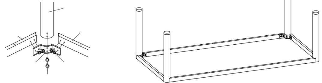
**手順2** 組立てたフレームに 天板を乗せ、メジャーや定規などで天板の側面から、桁フレームの側面までの寸法A・B・C・Dを計り、天板を取り付ける位置決めをしてください。それから、電気ドライバーなどで 木ネジで天板を止めて完成です。
