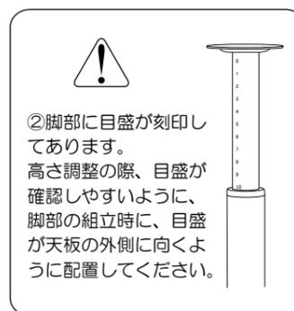
②脚部に目盛が刻印してあります。高さ調整の際、目盛が確認しやすいように、脚部の組立時に、目盛が天板の外側に向くように配置してください。
