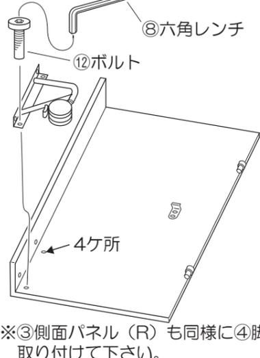
※③側面パネル(R)も同様に④脚を取り付けて下さい。
