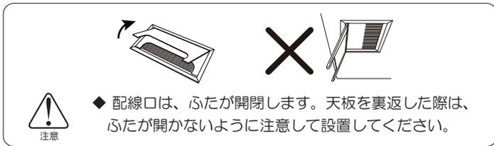
①天板をナットのついている面が上になるように平坦な場所に天板に装着された配線口のアルミ製のふたが開かないように配置してください。
