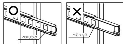
下段引出しをはめる際は、本体レールの内側のベアリング部分が、レールの一番前にある状態で引出しのレールに差し込んでください。（ベアリング部分が奥に入り込んだ状態ですと引出しが正しく入りません。）
