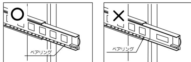
下段引出しをはめる際は、本体レールの内側のベアリング部分が、レールの一番前にある状態で引出しのレールにさし込んでください。(ベアリング部分が奥に入り込んだ状態ですと引出しが正しく入りません。)
