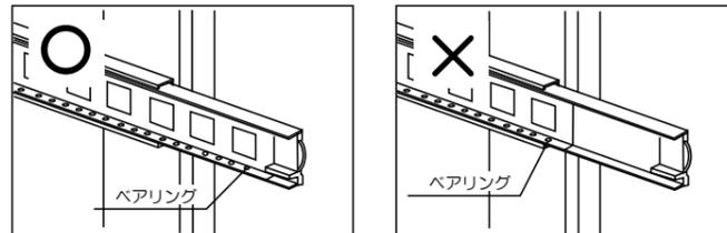
下段引出しをはめる際は、本体レールの内側のベアリング部分が、レールの一番前にある状態で引出しのレールにさし込んでください。(ベアリング部分が奥に入り込んだ状態ですと引出しが正しく入りません。)
