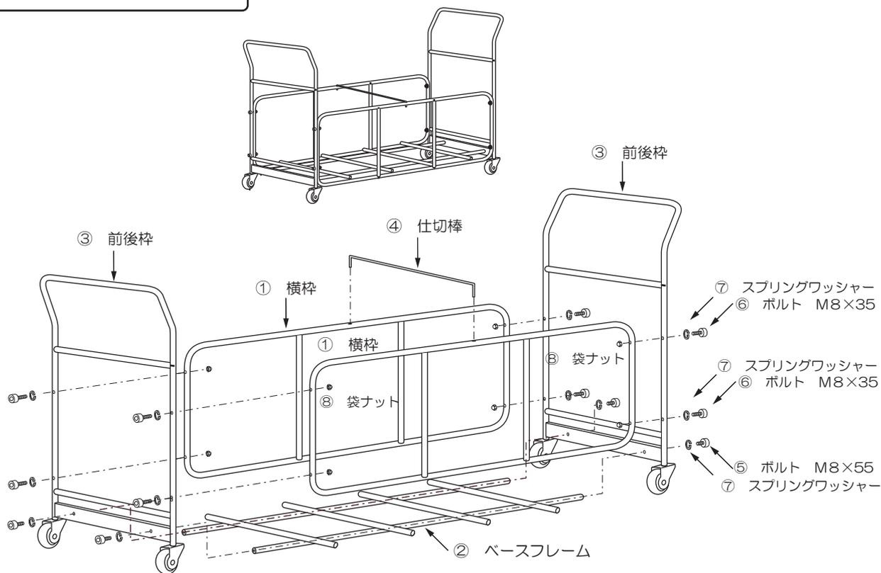
**手順1** ②ベースフレームと③横枠を、⑤ボルト（M8×55）に⑦スプリングワッシャーを入れ、⑨六角レンチを使用し仮留めする。
