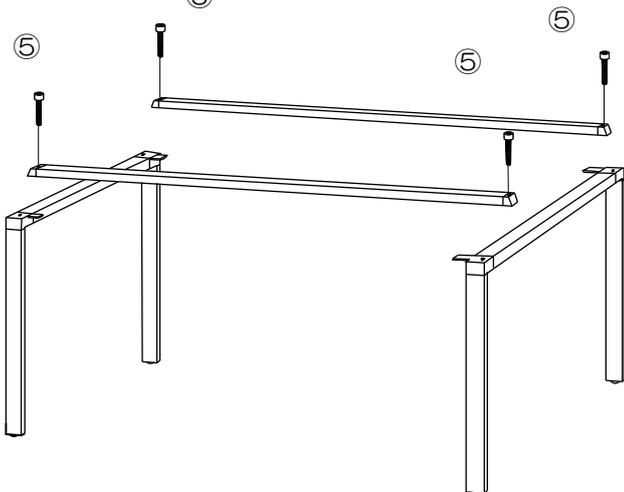
**手順3** **手順2** で組付けたフレームの桁フレームと天板①に六角レンチ⑨でボルト⑦を締めプラスドライバーで⑦⑧ボルトを締めてください。
